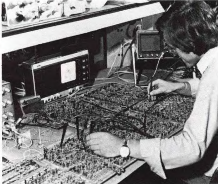
Afb. 3. Een ontwerper van geïntegreerde schakelingen achter een 'broodplank'. Door middel van losse componenten wordt de gewenste schakeling eerst opgebouwd.
